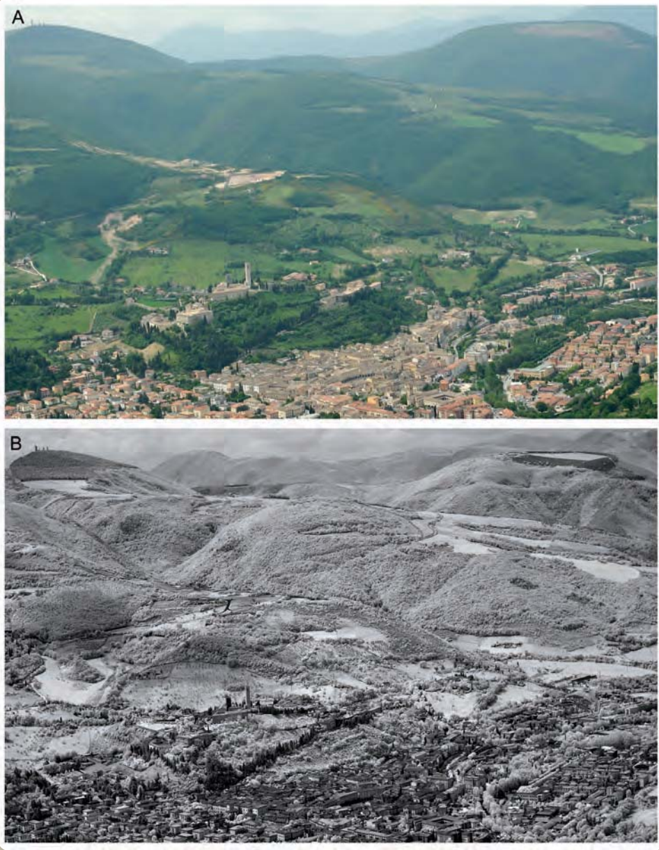
Figuur 14. Het verschil tussen een conventionele luchtfoto (A) en een nabij-infrarode opname (B). Bemerk de heldere weergave van (B) voor verafgelegen gebieden, te wijten aan de fysische eigen- schappen van deze onzichtbare straling (Verhoeven 2008, fig. 13)
